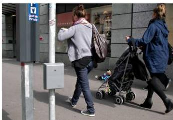
Nebeneinander abgebildete Pyro-Box ist seit Mitte September 2011 zu Testzwecken in der Innenstadt von Zürich installiert (im Bild an der Seefeldstrasse). Sie ist mit zwei Sensorpaaren ausgestattet – einem normalen Sensorpaar mit einer Reichweite von rund 4 Metern und einem zweiten Zoom-Sensorpaar mit einer Reichweite von bis zu 15 Metern.
