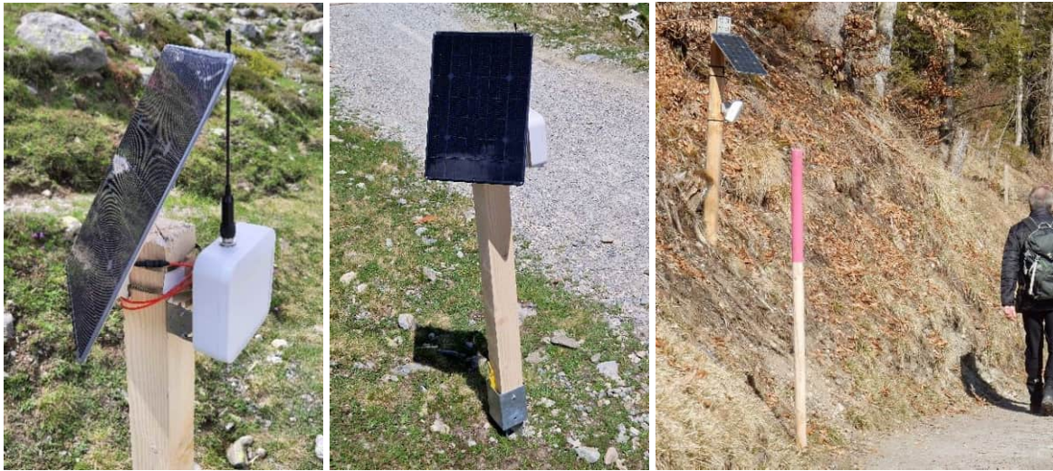
Abbildung 6: Links und Mitte: XCR-Radarsensor mit Solarpanel der Firma Parametric. Rechts: Beispiel für ein höher montiertes Gerät in Engelberg.
