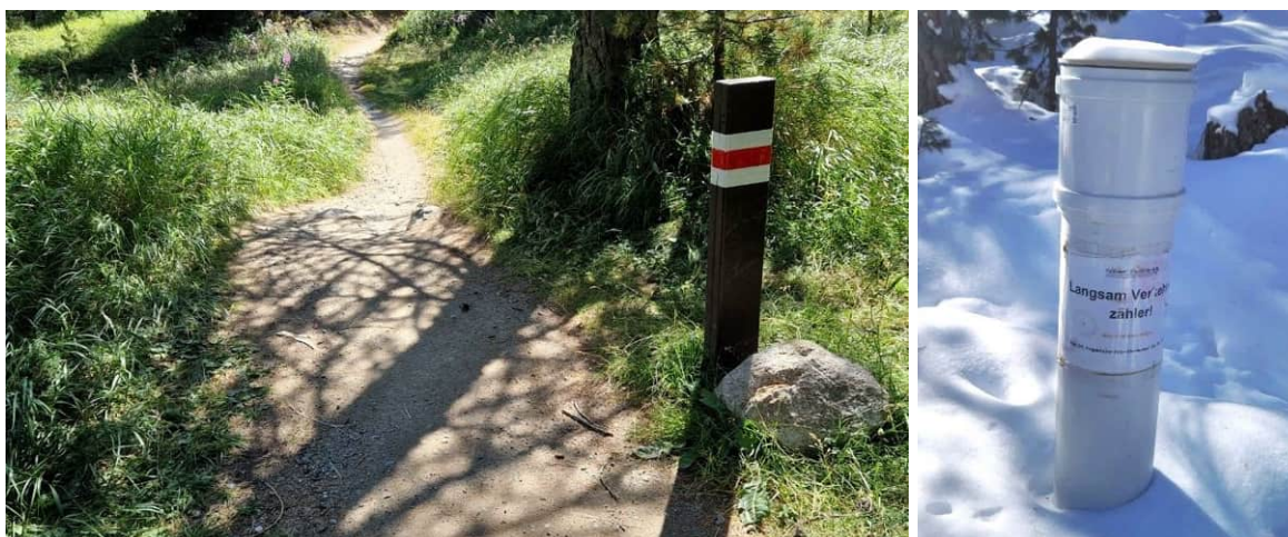
Abbildung 16: Fest installiertes Zählgerät (Eco MULTI von Eco-Counter) des Kantons Graubünden am kombinierten Wanderweg/Mountainbiketrail zwischen Morteratsch und Bernina Suot.
