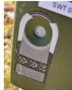
Abbildung 15: Kondenswasser im Gerät Swiss BIKE+PED light, festgestellt am 22. September 2023
