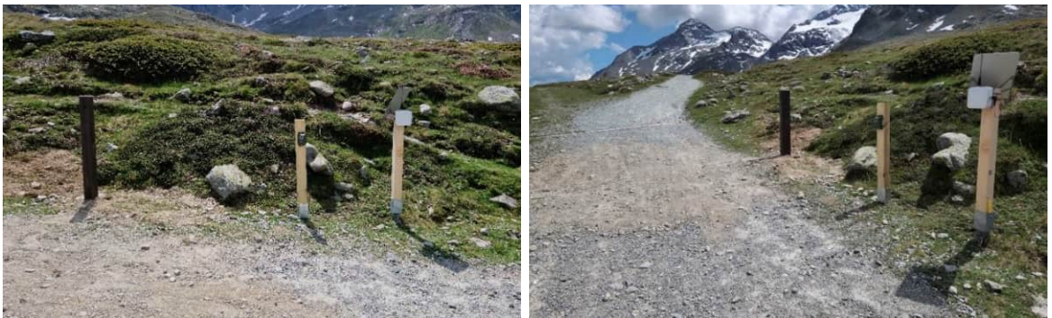
Abbildung 9: Zählstelle im Gefälle: von links nach rechts: Eco MULTI (Eco-Counter), Swiss BIKE+PED light (Swisstraffic) und XCR (Parametric). Bild rechts Blickrichtung Pass.
